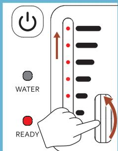
抽出量調節ダイヤルを回しランプが全点灯の状態にセットします。
